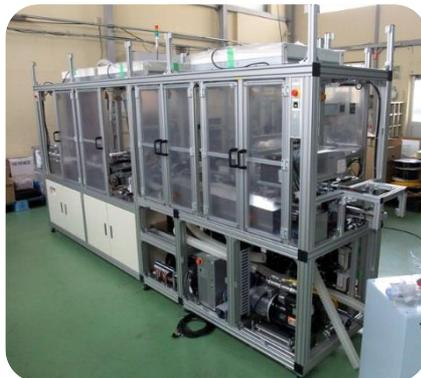
カートリッジの組立、検査、動作検査を行う製品
