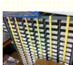
部材棚の飛び出し防止
