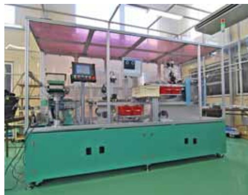
自動車用ギア外観検査機(元町)
